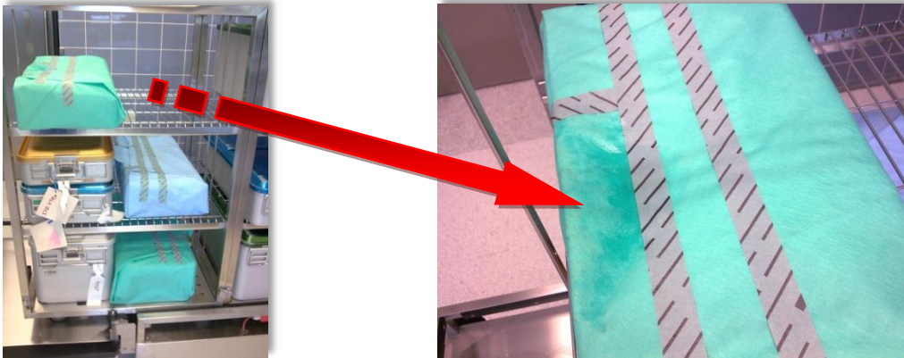
Figure 30. Constat d'humidité importante sur un paquet emballé avec un tissu poreux
