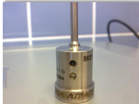
Figure 28. Sonde embarqué avec DEL et phototransistor
