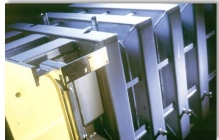
Figure 22. Double enveloppe de la cuve (on distingue les traverses extérieures conduisant la vapeur)
